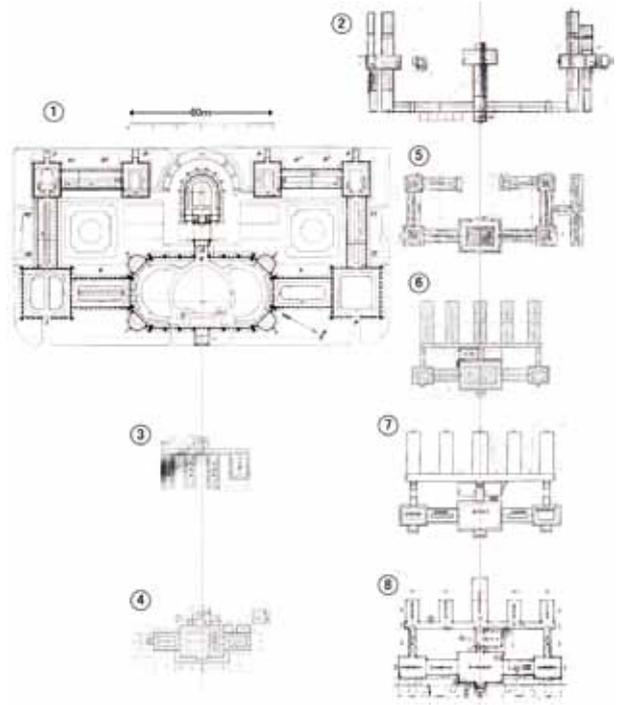
図6 同一縮尺で見る温室平面図。①：ドイツ・ゲーレン植物園(Ministerium der Geistlichen et al. 1909の巻末折込地図。天地逆で示す)。②：新宿御苑(新宿御苑 1936)。③：岐阜高等農林学校温室(太田 1927。縮尺不明のため推定で示す)。④：宝塚植物園(宝塚植物園 1954)。⑤：東山植物園・水野第一案。⑥：東山植物園・水野第二案。⑦：東山植物園・発注直前状況図面(一圓の図などを元に作成)。⑧：東山植物園・竣工時図面(一圓の自筆)。⑤から⑧は東山植物園所蔵の図より加工。尚、東山植物園温室工事の発注時および竣工時の正式図面は残っていない。
